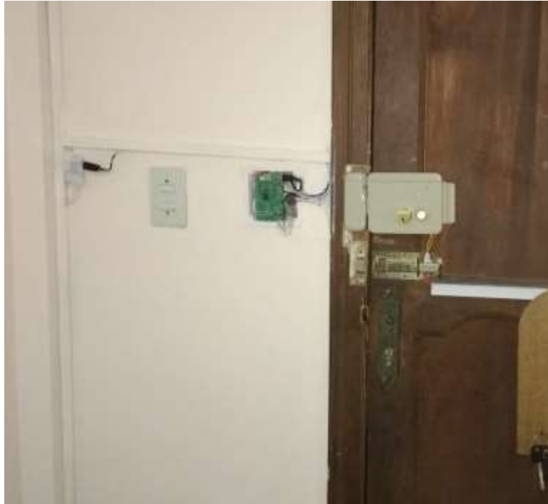
Figura 3.39: Sistema de Control de Ingresos no autorizados a un Ambiente Fuente: (Elaboración Propia)
