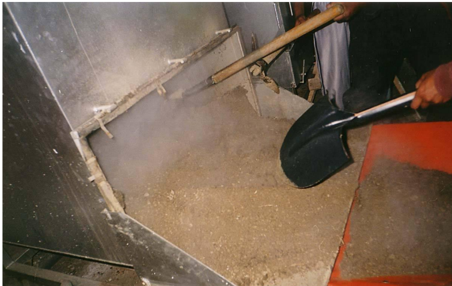
Fotografía 6. Descarga del sustrato desinfectado
