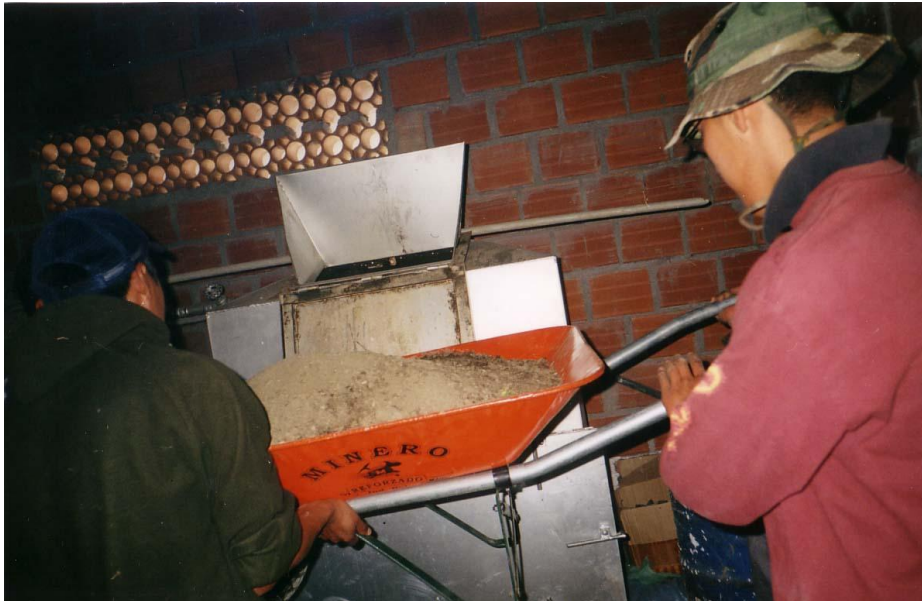
Fotografía 5. Alimentación de sustrato a la cámara de desinfección
