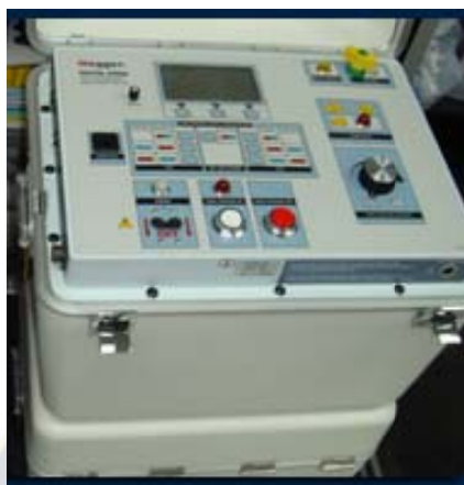
FIGURA 2.45 PANEL DE LA UNIDAD DE MEDICIÓN Y TRANSFORMACIÓN DE UN MEDIDOR DE F.P. DE 10 KV
