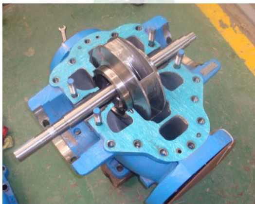
Figura. 2.12 Bomba horizontal de carcasa partida doble succión.
