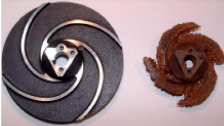
Figura. 2.25 Cavitación por erosión.
