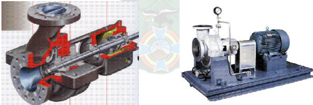
Figura. 2.5 Bomba Unietapa de succión sencilla radialmente partida, impulsor en voladizo, apoyo en centro.
