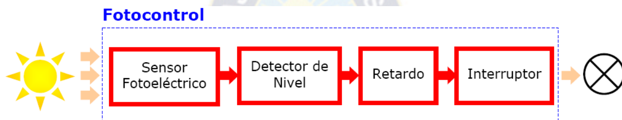
Figura 3. 3 Diagrama en bloques de un interruptor fotoeléctrico
