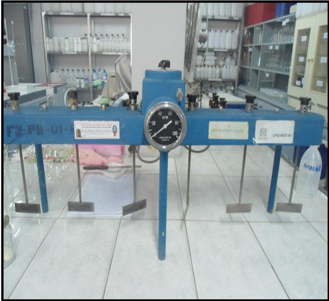
Fotografía N°20: Equipo de prueba de jarras usado
