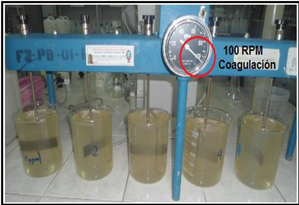
Fotografía N° 25: Adición de coagulante y etapa de coagulación
