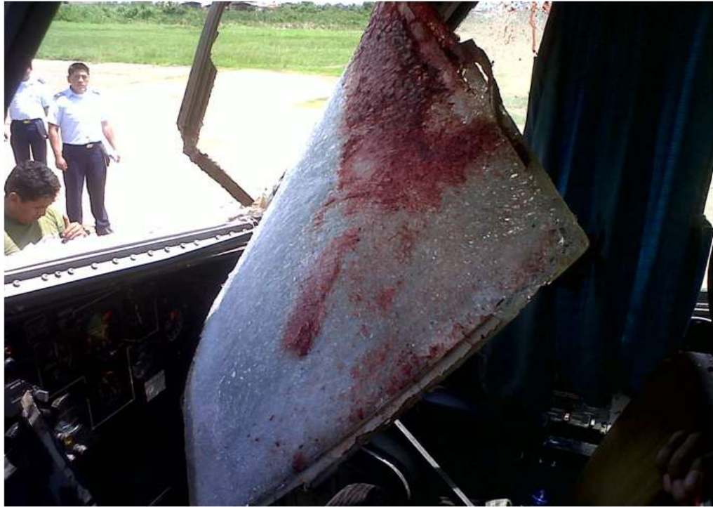
Figura N ° 16. Accidentes provocados por la presencia de aves en el aeropuerto Jorge Henrich Araúz.
