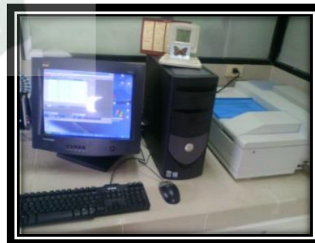
Figura 3.42. Lectura de fósforo total en el equipo de espectroscopia UV/VIS.
