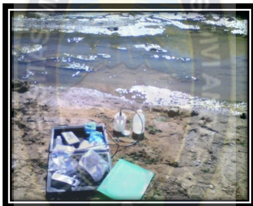
Figura 3.16. Medición de la conductividad en campo.
