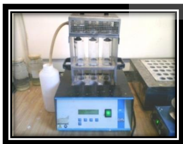
Figura 3.26. Digestión de las muestras para su posterior destilación.
