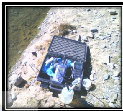
Figura 3.18. Análisis de pH en campo para muestras de aguas.
