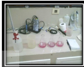
Figura 3.29. Muestras valoradas en el punto final de viraje a lavanda con ácido sulfúrico 0,012 N.
