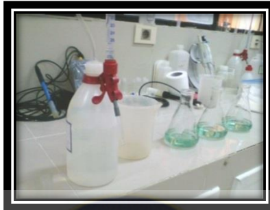
Figura 3.32. Valoración de las muestras de suelos y sedimentos destilados con ácido sulfúrico 0,12 N.
