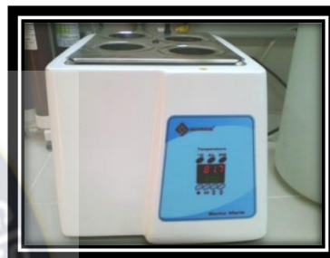
Figura 3.23. Secado de las cápsulas con muestra de agua en el equipo de baño María.
