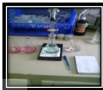
Figura 3.36. Valoración del destilado de nitrógeno con ácido sulfúrico 0,0992 N.
