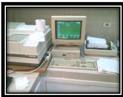
Figura 3.61. Lectura de nitratos en el equipo espectrofotométrico UV/VIS.
