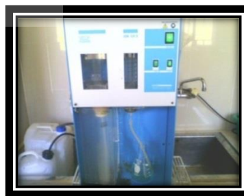
Figura 3.27. Destilación en el equipo Kjeldahl.
