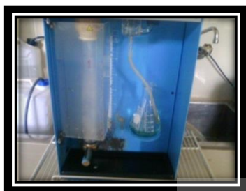
Figura 3.35. Destilado de Nitrógeno en el equipo Kjeldahl en muestras de Forraje.
