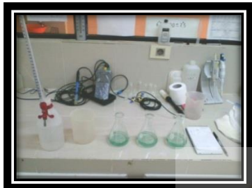
Figura 3.28. Muestras destiladas preparadas para su valoración con ácido sulfúrico.
