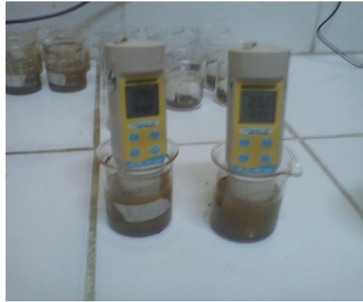
Determinación de la Conductividad Eléctrica y el pH
