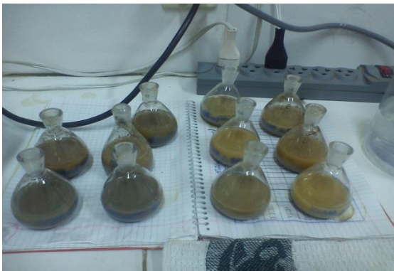
Determinación de la densidad real por el método del picnómetro
