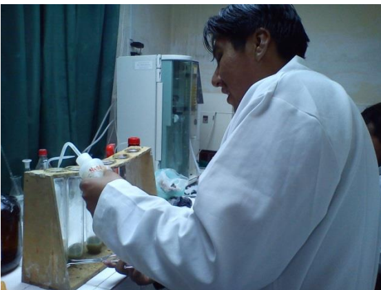
Neutralización y digestión de las muestras en el equipo Kjeldhal
