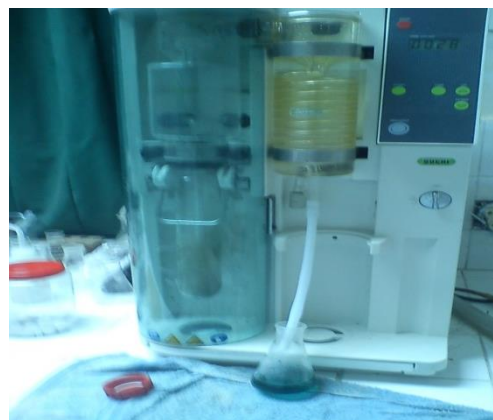
Neutralización y digestión de las muestras en el equipo Kjeldhal
