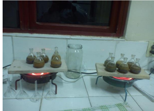
Determinación de la densidad real por el método del picnómetro
