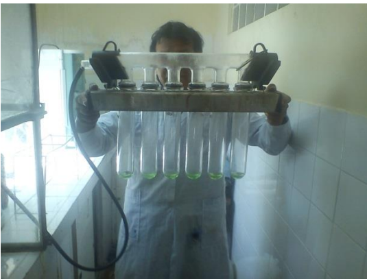
Digestion de las muestras en el equipo Kjeldhal
