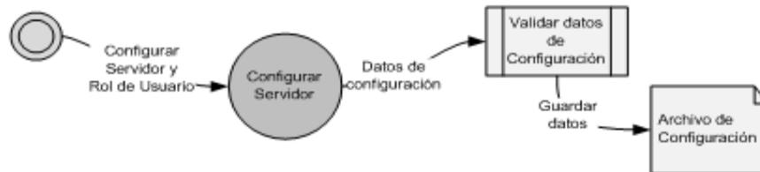
**Figura 2.11.2.4.b. Diagrama de Representación Nivel 2 – Configuración del Servidor**
