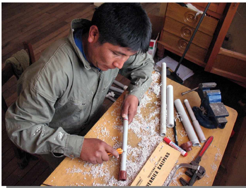
Proceso de construcción del aspersor artesanal
