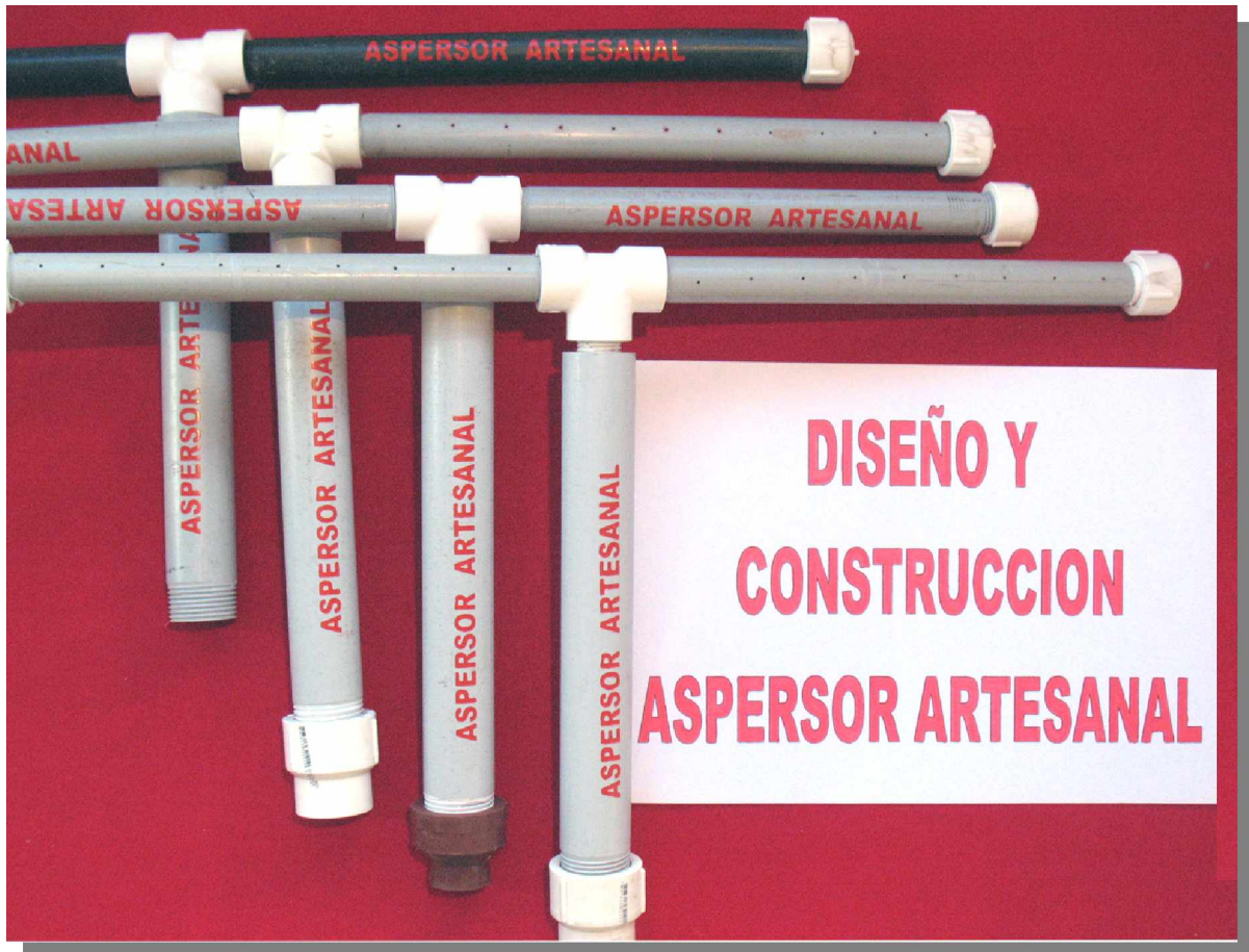
Figura 14. El producto final del proceso de construcción del aspersor artesanal
