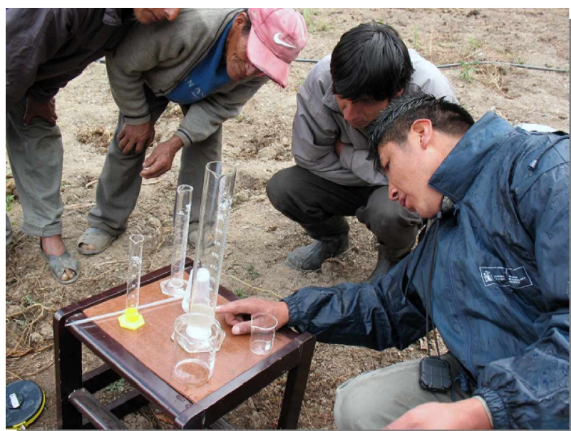
Medición del volumen de agua en los pluviómetros
