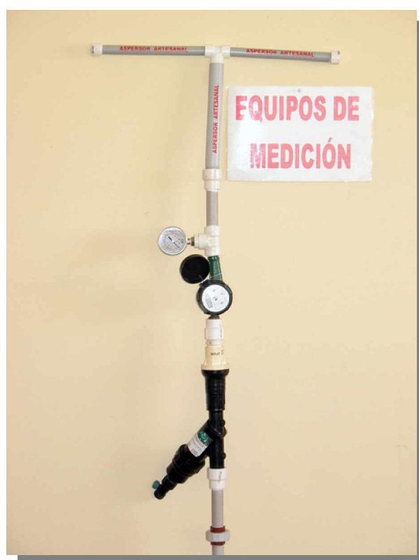
Aspersor con equipos de medición
