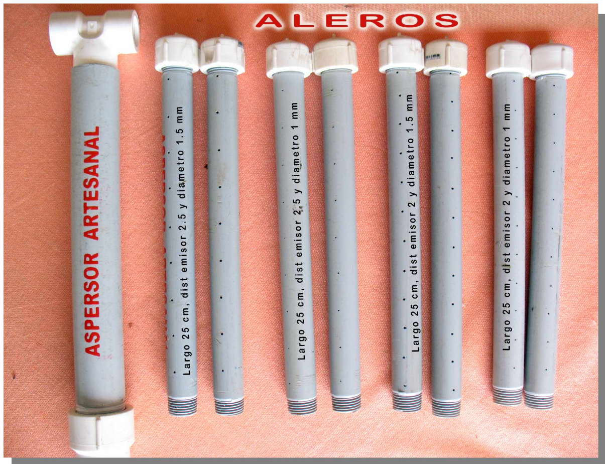
Figura 18. Aspersion artesanal y sus respectivos aleros
