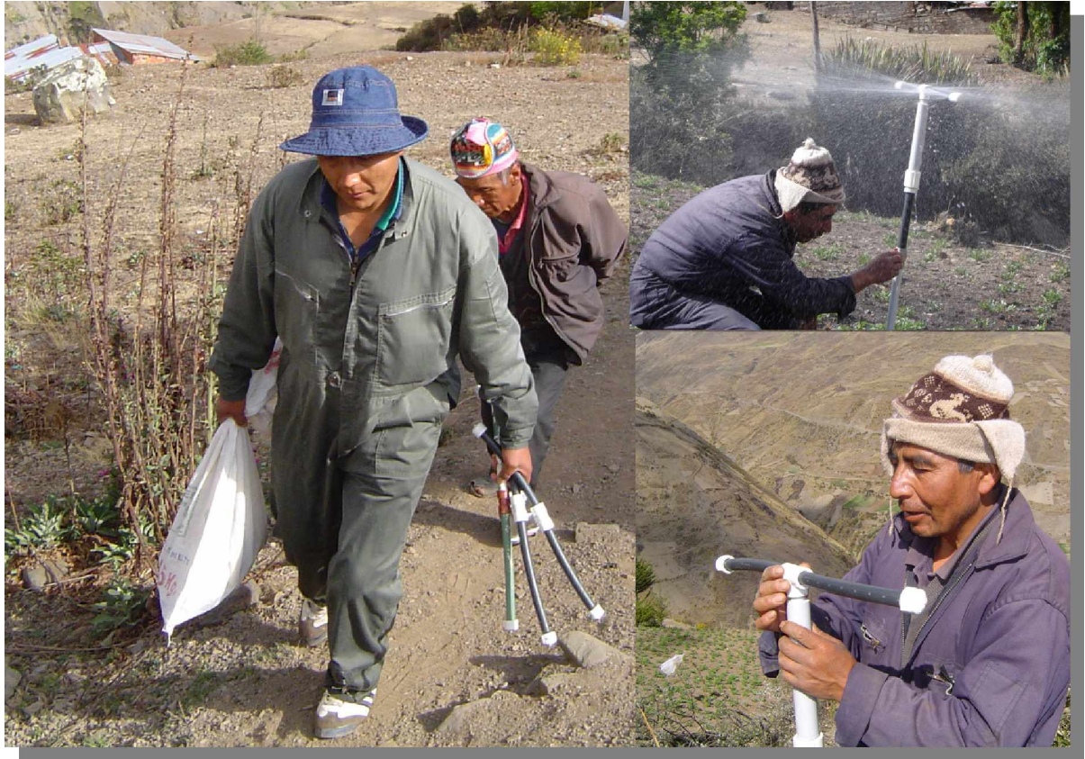
Figura 17. Realización de pruebas del aspersor artesanal en campo
