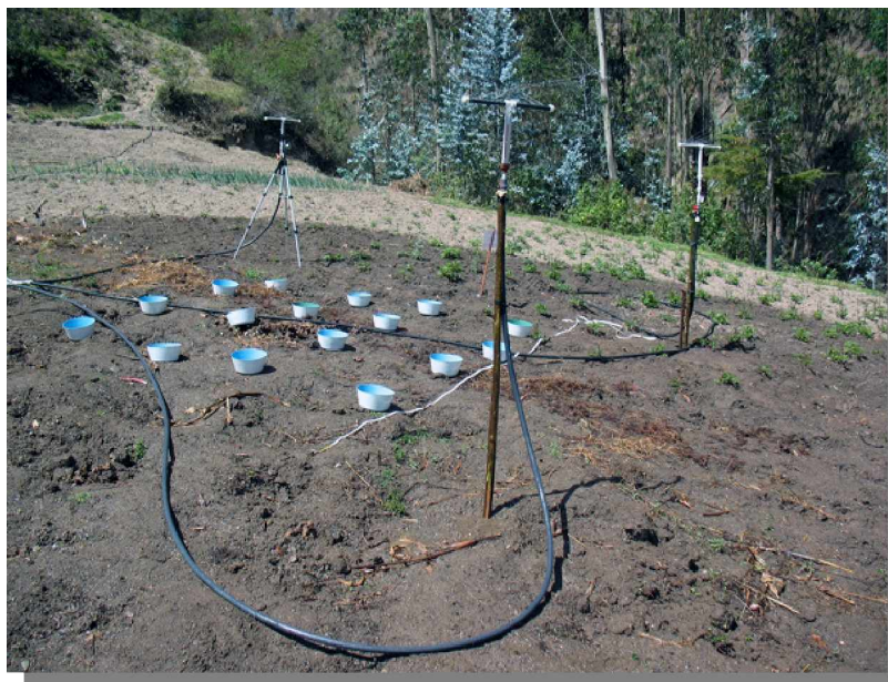
Red de aspersores y pluviómetros para la medición de CU.
