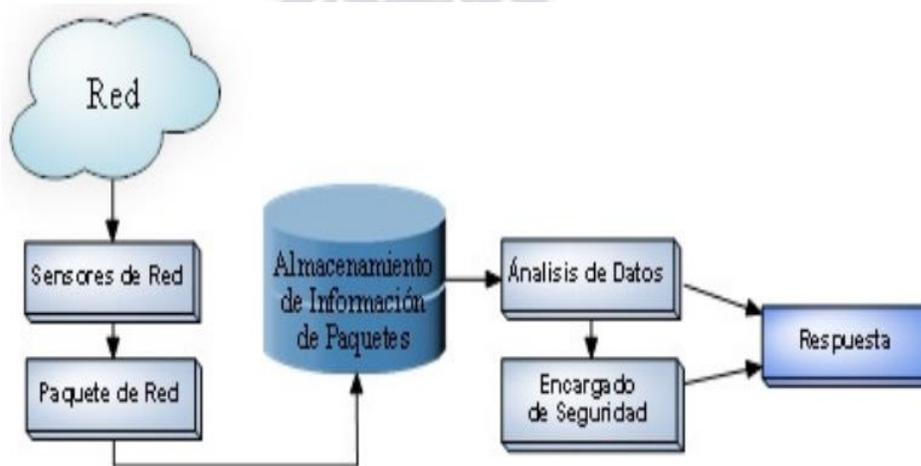
Figura 2-6: Sistema de detección de intrusos basado en red
