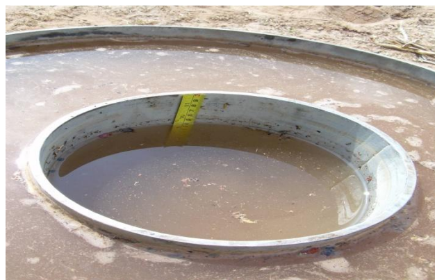
Figura 6. Determinación de la velocidad de infiltración básica por el método del doble anillo
