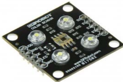
Figura 2.5: Sensor de color TCS3200 Fuente: (Electronilab, 2015)
