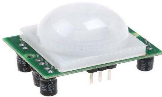
Figura 2.4: Sensor de movimiento PIR HC-SR501 Fuente: (Electronilab, 2015)
