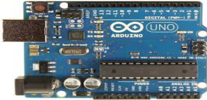
Figura 2.3: Placa Arduino UNO Fuente: (Arduino, 2014).
