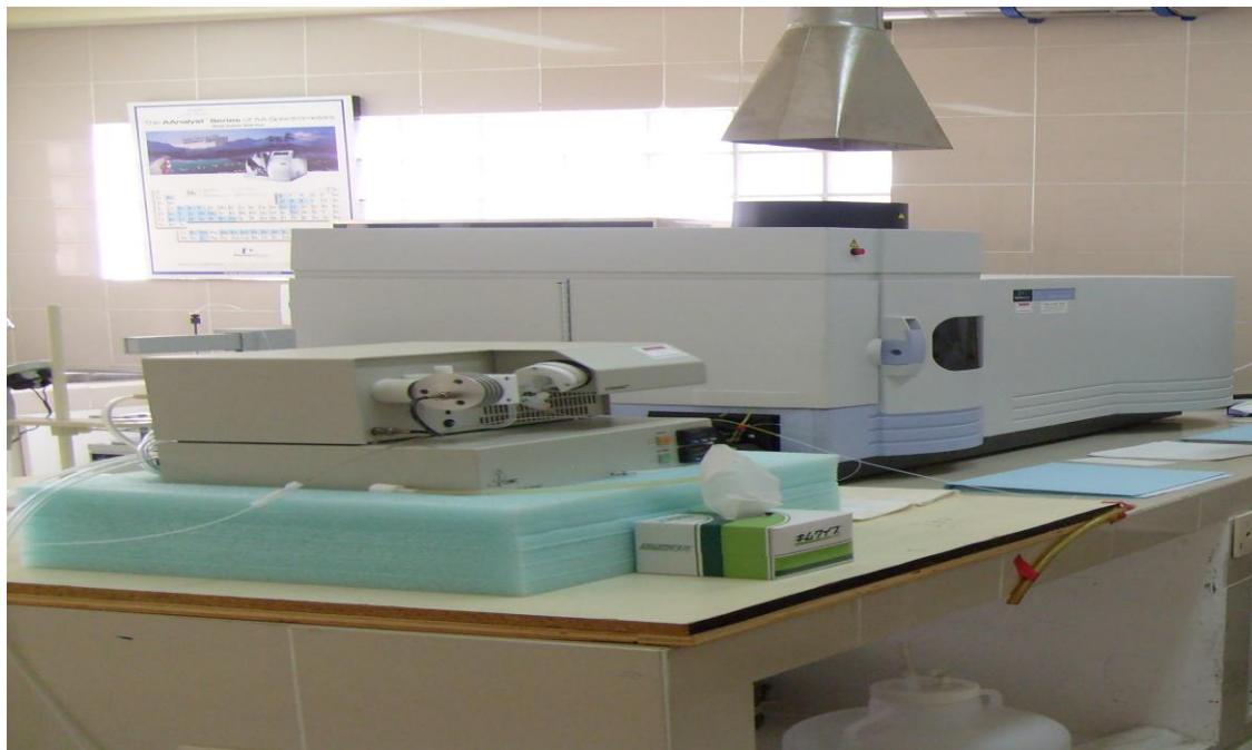
Foto N° 12. Equipo ICP-OES, para el análisis de las muestras para su análisis físico-químico laboratorio de Químico del IGMA Campus Universitario de Cota Cota.
