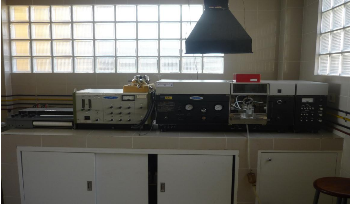
Foto N° 11. Absorción atómica Hitachi, para el análisis de las muestras para su análisis físico-químico laboratorio de Químico del IGMA Campus Universitario de Cota Cota.
