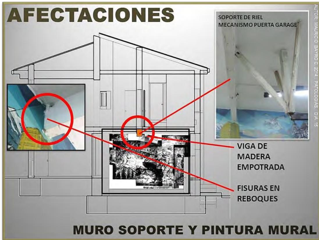
Ilustración 103. Viga de madera empotrada 1
