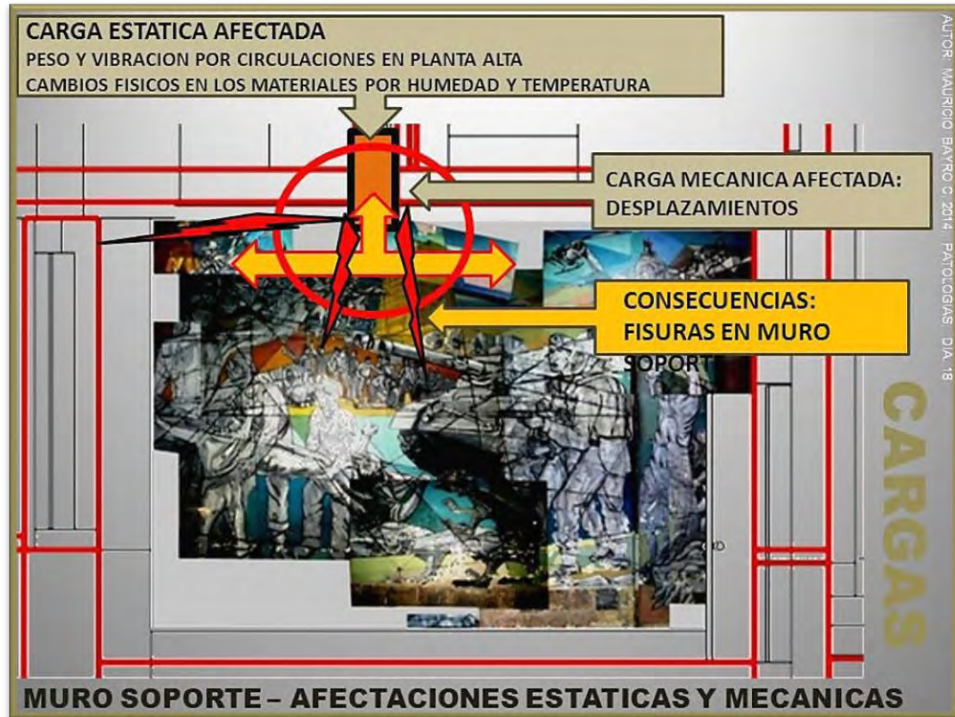
Ilustración 105. Fisuras y roturas en el muro. 1
