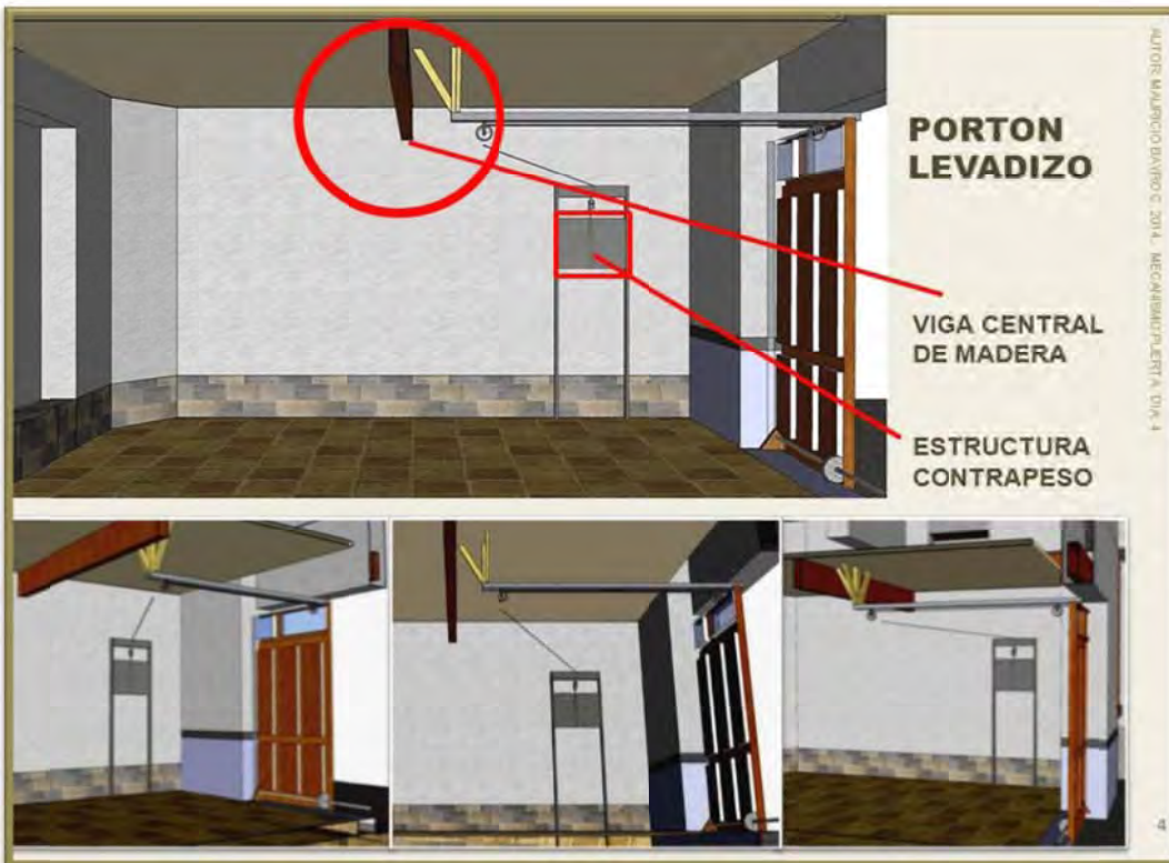
Ilustración A5. 4. Estructura. Mecanismo y contrapeso.
