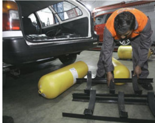
Ilustración 6 Conversión Vehicular a GNV
