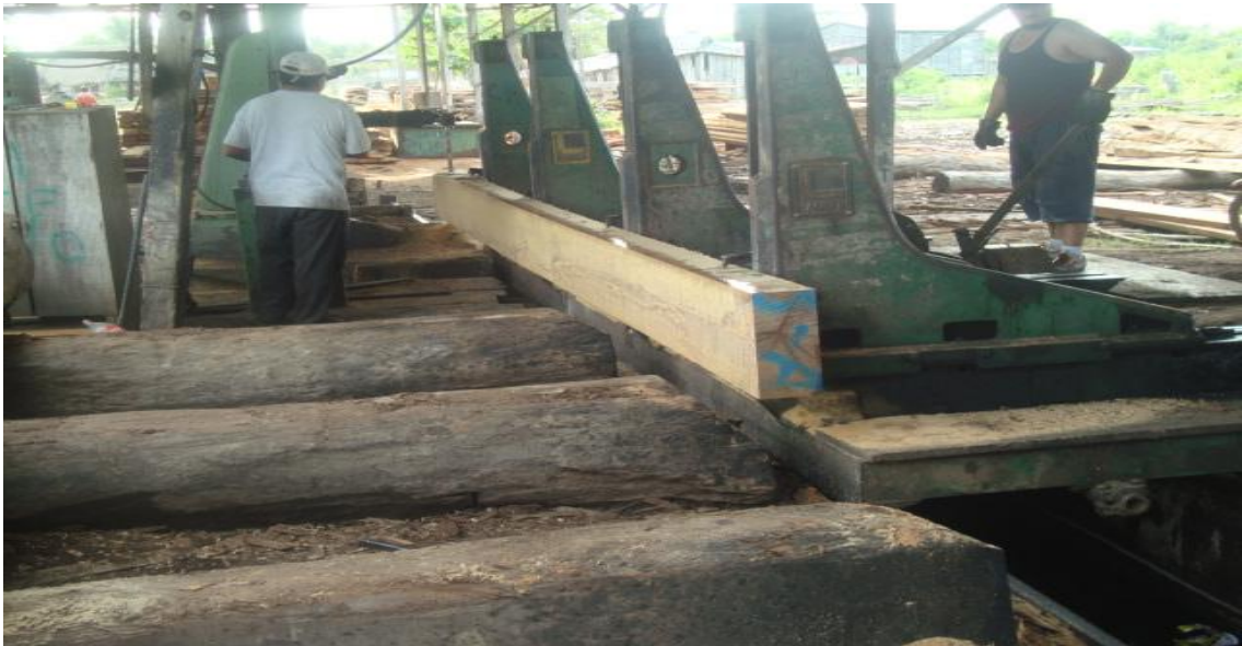
Figura 21 Cinteadora tableando la madera cedro en 1, 2, 3 pulgadas de grosor
