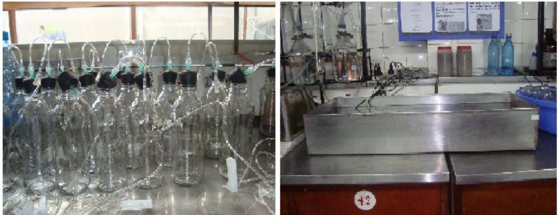
Figura 9: Botellones y fuente para la biodigestión
