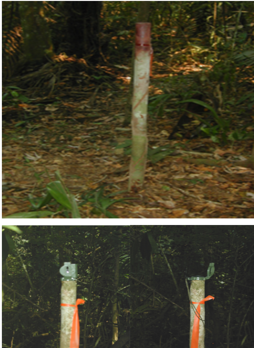
Figura 7. Jalón principal (00) del cual se partió y ubicación de la brújula en una estaca para seguir el rumbo correcto en la instalación de las parcelas.
