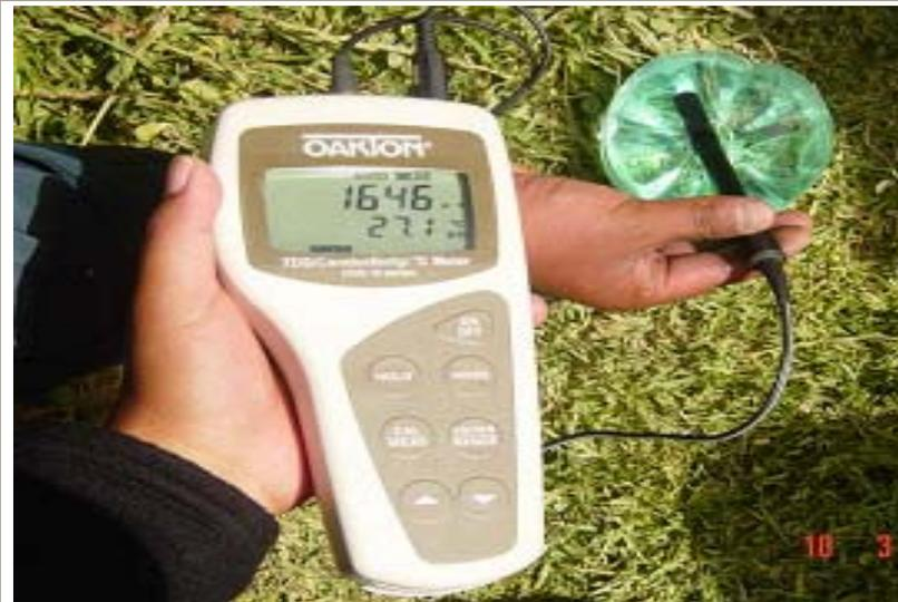
**Conductímetro para medir conductividad eléctrica de la solución de nutrientes**
