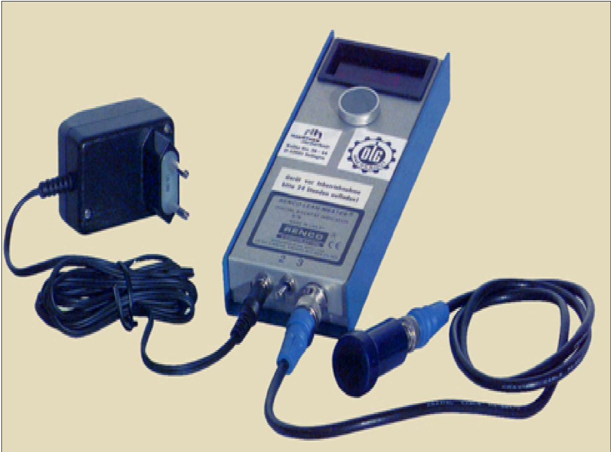
Fotografía 1: Equipo LEAN-MEATER (Detector de grasa, aparato para medir el tocino en entre 3 a 45 mm de la zona dorsal).-
