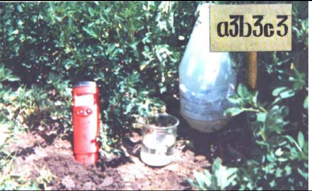
A.40. Pruebas del pH del suelo mediante el Water PROF HI 8857
