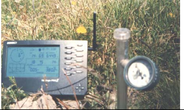
A.39. Medición de la humedad del suelo mediante tensiómetros y el sensor de humedad de la estación meteorológica Vantage PRO-2
