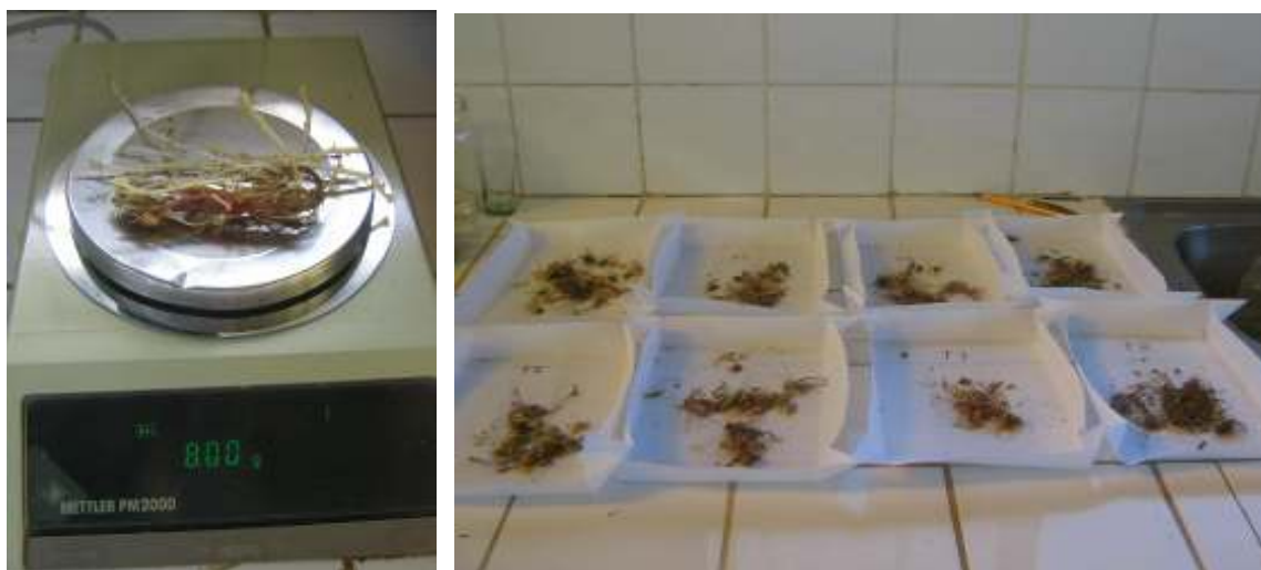
Figura 23. Peso de la raíz y muestras para determinar la humedad de la raíz
