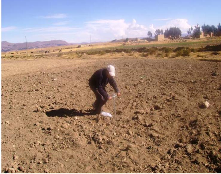
**Foto 5. Muestreado de suelo para análisis de humedad y densidad aparente (post Cosecha)**
