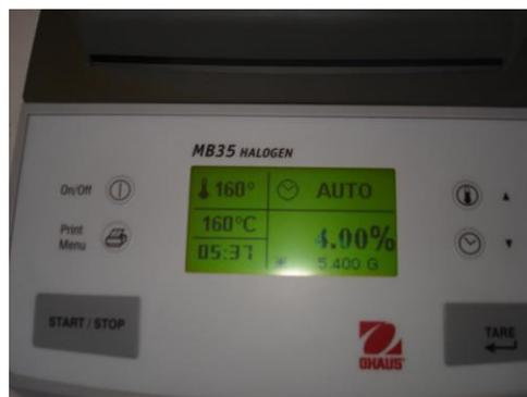
**Figura 8:** Determinación de la humedad
