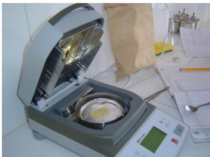
**Figura 13:** Determinación del contenido de humedad de las semillas de quinua
