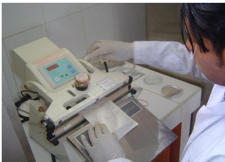
**Figura 15:** Sellado al vacío de los sobres de aluminio trilaminado con semillas
