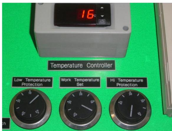
**Figura 11:** Programación de la temperatura de trabajo del horno
