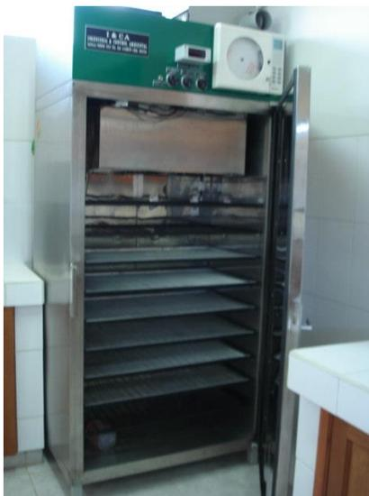
**Figura 9:** Horno desecador de semillas
