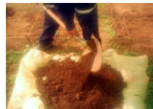
Figura 21. Homogeneización del suelo.
