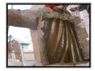
En este caso y por la complejidad del modelo, se pensó en moldes perdidos por ser un modelo único, hecho solo para la Casa de Oración. Una vez terminado el trabajo se marca cada uno de los moldes con diferentes colores haciendo los registros para poder armarlos y desarmarlos con facilidad.
