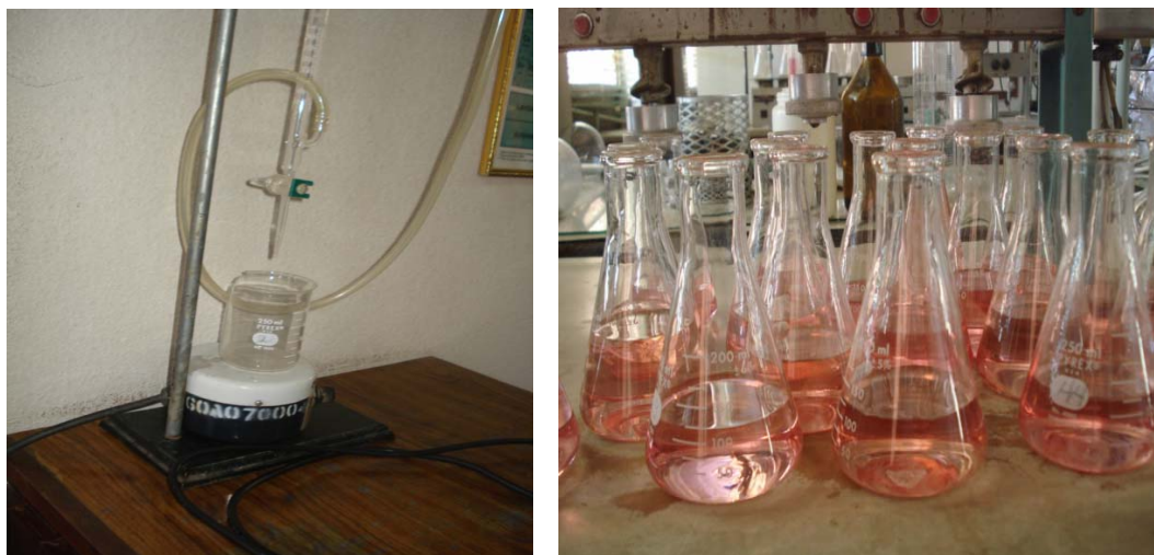
Figura 22. Equipo de titulación para la determinación de proteína
