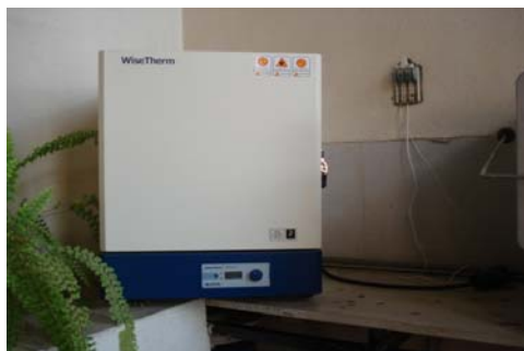
Figura 19. Horno de incineración para la obtención de ceniza.
