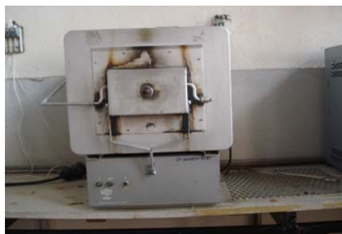
Figura 18. Mufla para la obtención de materia seca total
