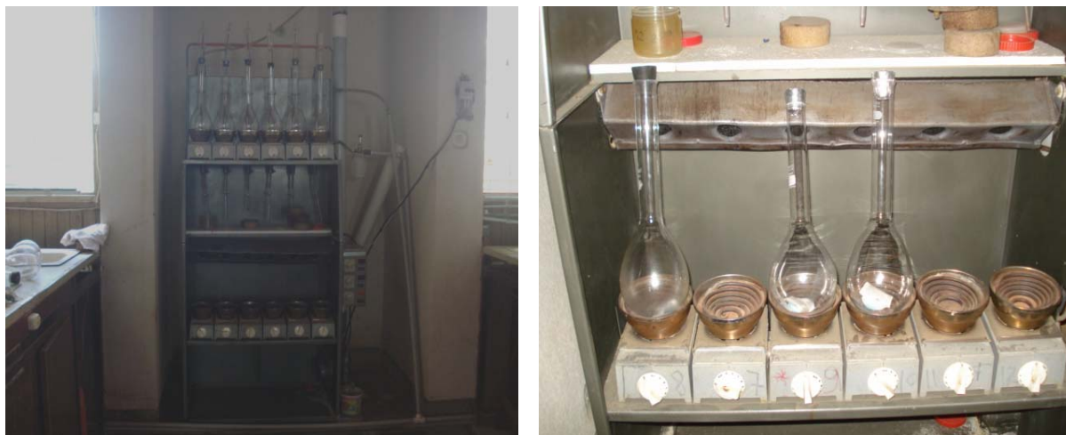
Figura 21. Equipo Kjeldahl para la determinación de proteína
