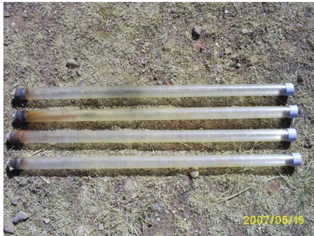
20-q. Tubos de acceso (para la sonda del T.D.R.)
