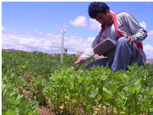
20-l. Medición de la conductancia estomática en hojas de quinua con el Porómetro
