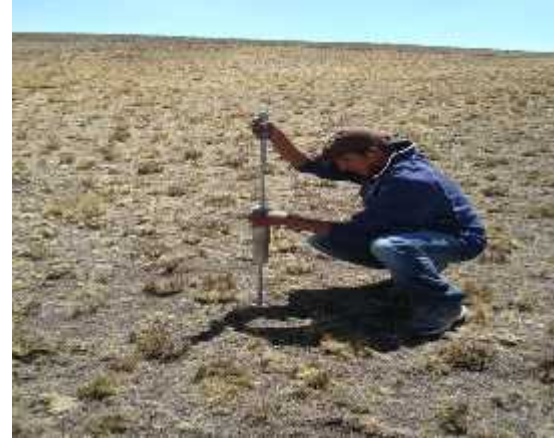
Penetrometro para muestra de suelos
