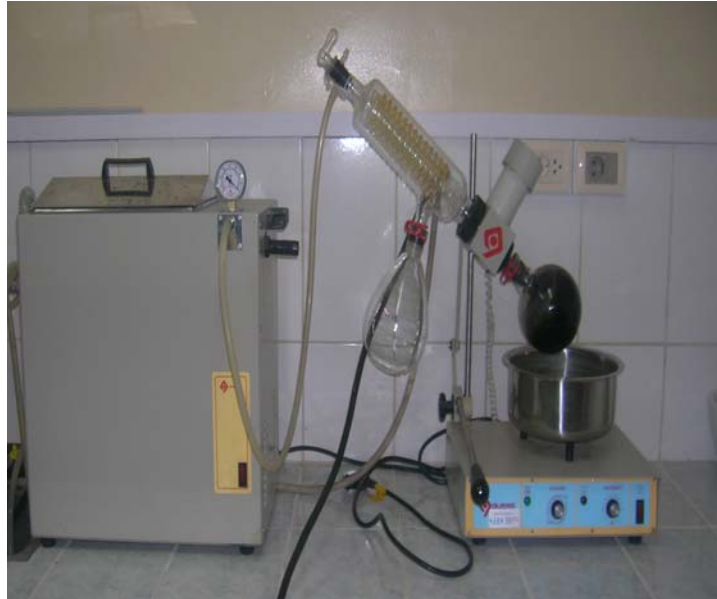
Fotografía N° 7. Equipo de rota – evaporación
