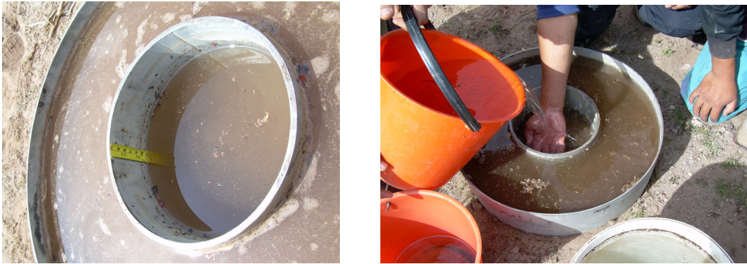
Figura 5. Determinación de la velocidad de infiltración básica por el método del doble anillo
