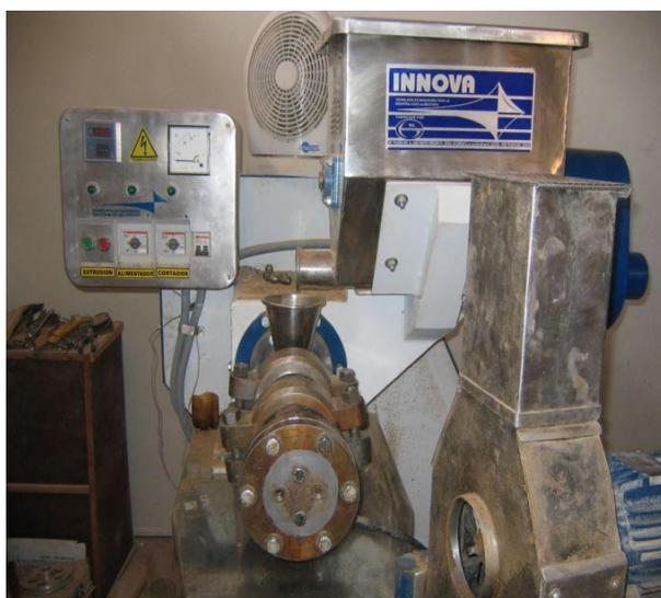
Figura 3. Maquinaria que elabora el alimento extruido pelletizado
