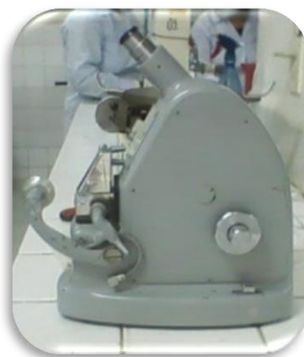
Figura N°25: Brixometro, para determinar los °Brix de la Frutilla
