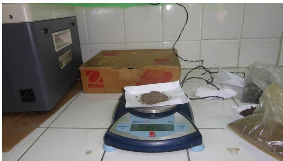
Fotografía N° 21 Determinando densidad aparente y real de los sustratos
