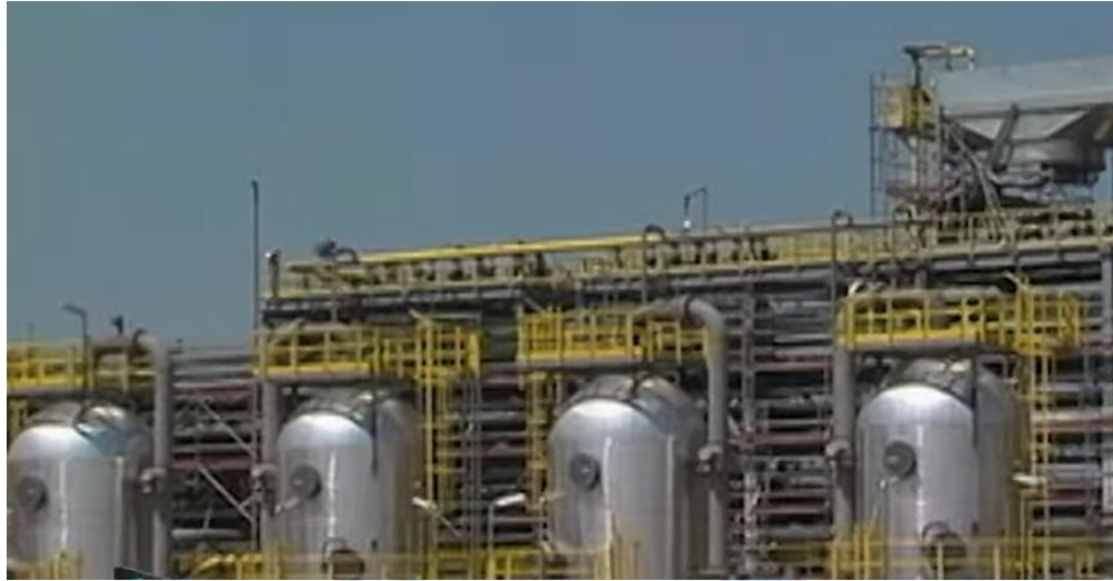
Figura 3.10. Unidad de Deshidratación con Tamices Moleculares en PSLCV
