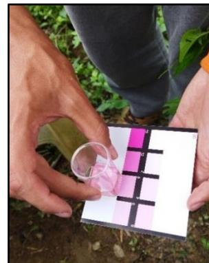
Control físico-químico del agua previo al acondicionamiento del estanque
