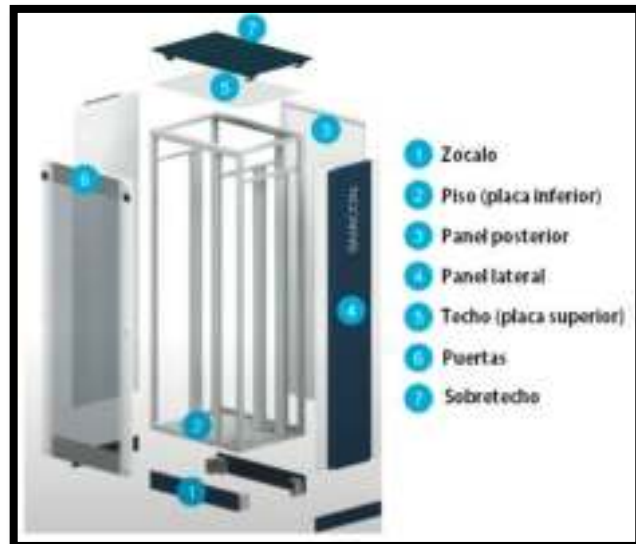
Figura 2.5. Estructura metálica con perfiles y placas de chapa de acero inoxidable (gabinete)
