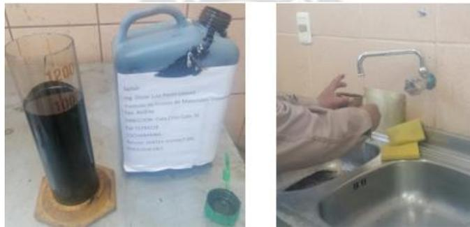
Se lava hasta que la muestra salga limpia, se la coloca al horno durante 2 horas a 100°C, luego se lo deja enfriar a temperatura ambiente y se lo pesa nuevamente. A continuación, se calculará el porcentaje de retenido en el tamiz de 850  $\mu\text{m}$  de una muestra de la emulsión y las demás serán expuestas en una tabla resumen.
