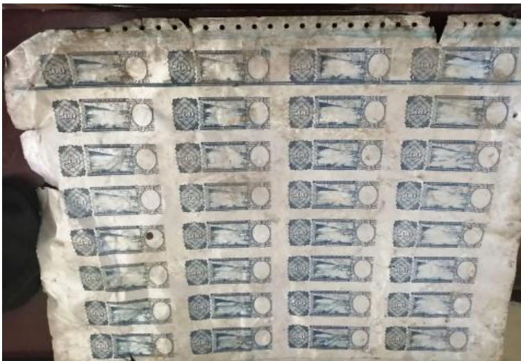
Figura 28 - Plancha de impresión de billetitos, tecnología Offset, Imprenta Popular Argote. Fotografía: MAD Ulupica, 2023
