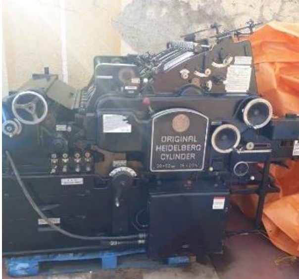
Figura 29 - Máquina de impresión Offset marca Heidelberg de los años 1960's, Imprenta Popular Argote, Fotografía de Archivo Fotográfico Imprenta Popular Argote 2023
