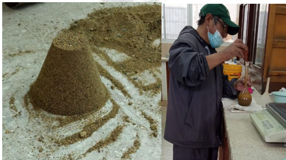
Figura 16 Muestra húmeda de agregado fino, Picnómetro mas muestra.
