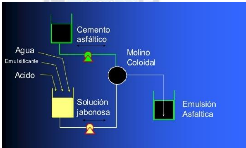
Ilustración 2 Producción de una Emulsión Asfáltica.
