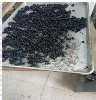
Figura38 Mezclas asfálticas sin compactar.
