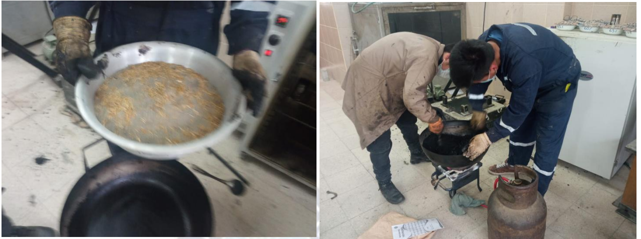
Figura41 Elaboración de probetas para mezclas asfálticas con fibra natural de totora.
