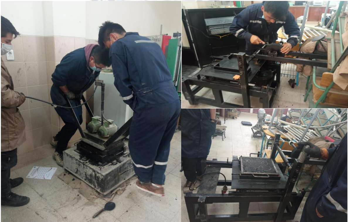
Figura42 Compactado, preparación de la maquina y colocado de la probeta en la máquina de ahuellamiento.
