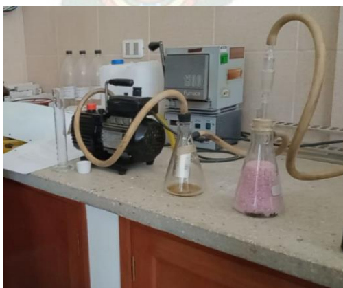
Figura 29 Solubilidad de materiales bituminosos.
