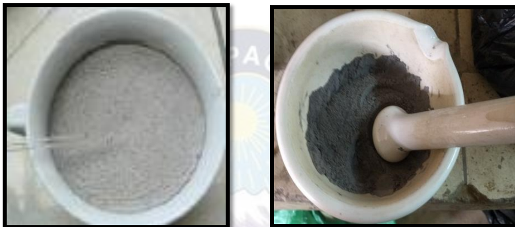
Figura 8. Ceniza reactiva color gris oscura a blanca.
