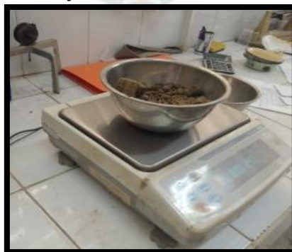
Figura 21. Ensayo de contenido de humedad.
