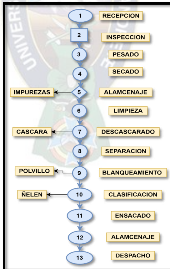
Figura 5. Flujograma de obtención del arroz.
