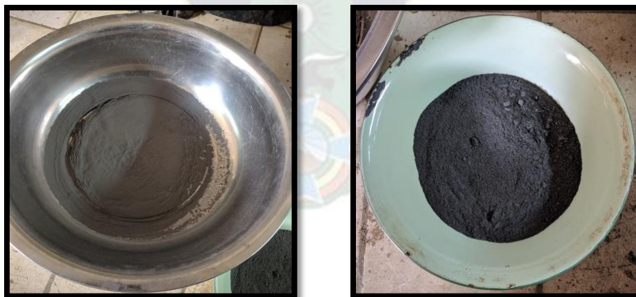
Figura 9. Ceniza de cascara de arroz después de la combustión controlada con un cierto porcentaje de carbono residual.
