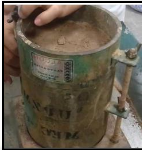
Figura 26. Molde para la compactación.
