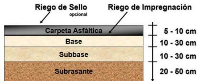
Figura 12. Partes de la sub-rasante.
