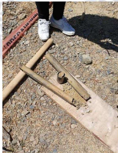
Fotografía 37. Se extrajeron muestras del terreno. Fuente: Elaboración propia
