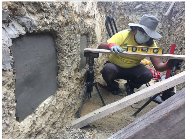
Fotografía 28. Verificación de la horizontalidad del equipo. Fuente: Elaboración propia
