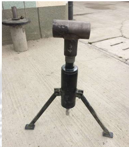
Fotografía 16. Soportes para mantener el equipo horizontal (gata hidráulica). Fuente: Elaboración propia
