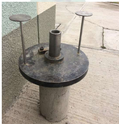
Fotografía 9. Disco de 0.30 m, se puede apreciar los discos donde se colocarán la punta de los extensómetros Fuente: Elaboración propia
