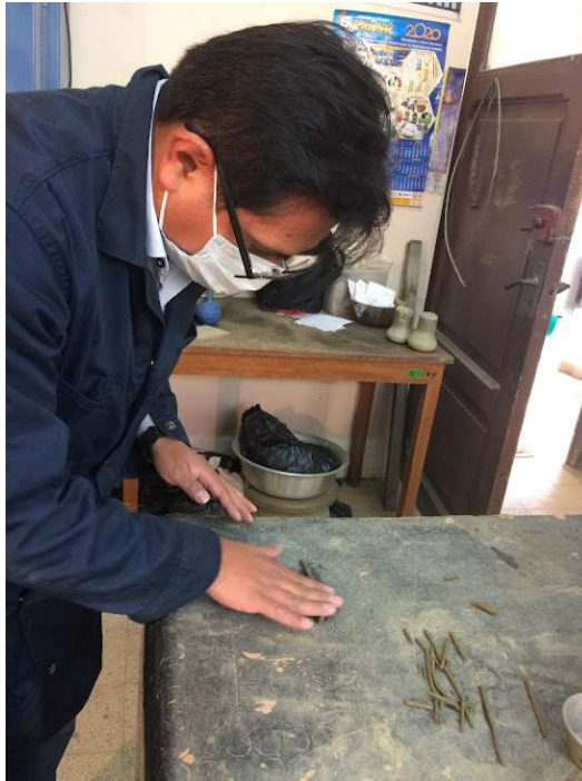
Fotografía 46. Realizando el ensayo para determinar el límite plástico del suelo.
