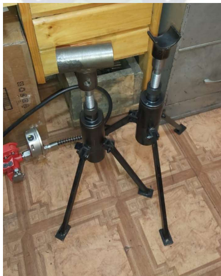
Fotografía 17. Soportes para mantener la gata hidráulica de manera horizontal. Fuente: Elaboración propia
