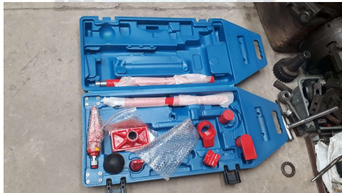
Fotografía 10. Partes componentes de la gata hidráulica empleada. Fuente: Elaboración propia
