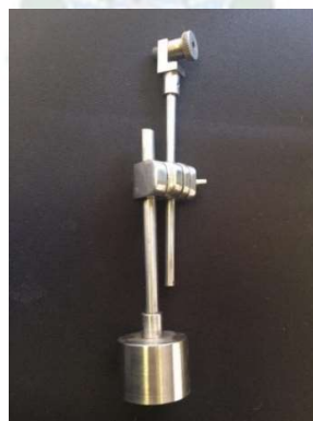
Fotografía 15. Accesorio para sostener los extensómetros.
