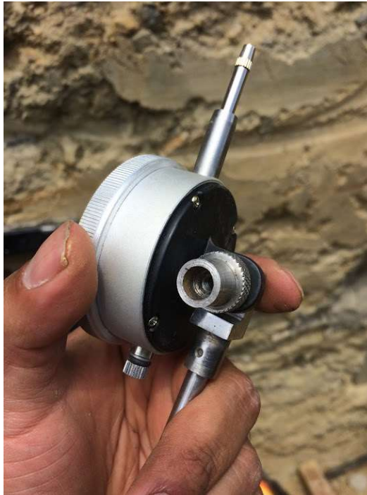
Fotografía 31. Con ayuda de un alicate se instalan los relojes comparadores a los porta extensómetros.
