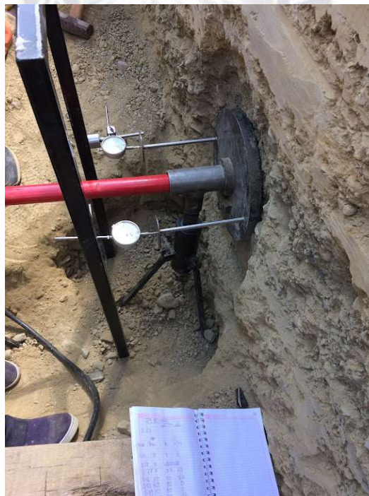
Fotografía 34. Extensómetros instalados. Fuente: Elaboración propia
