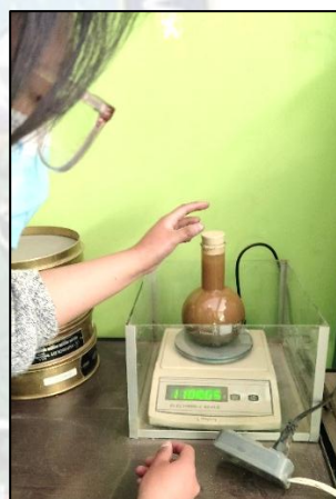
FOTOGRAFIA 21. PESO PICNÓMETRO MÁS MUESTRA
