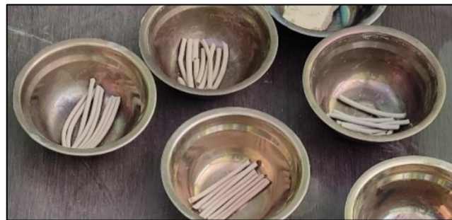
FOTOGRAFIA 18. ESTADO DE LIMITE PLÁSTICO DE MUESTRAS
