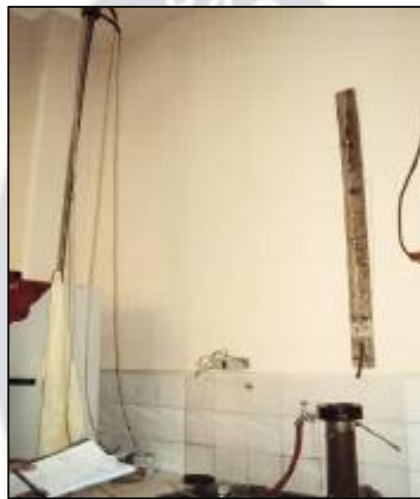
FOTOGRAFIA 33. EQUIPO ENSAYO DE PERMEABILIDAD CARGA CONSTANTE
