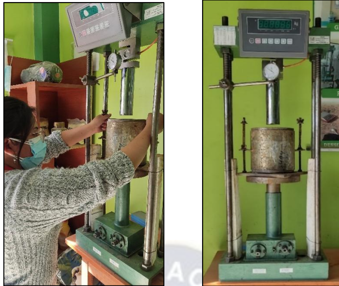
FOTOGRAFIA 32. LECTURAS DEL DEFORMÍMETRO -PRENSA CBR
