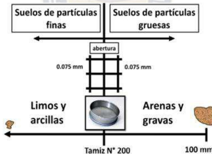
FIGURA 12. ESQUEMA DISTRIBUCIÓN DE PARTÍCULAS POR TAMAÑO (CLASIFICACIÓN SUCS)
