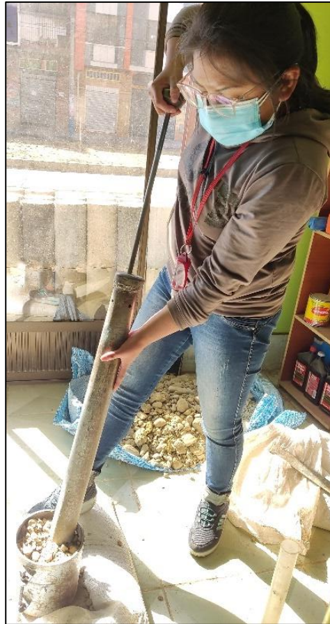
FOTOGRAFIA 30. COMPACTACIÓN DE MOLDES (C.B.R.)
