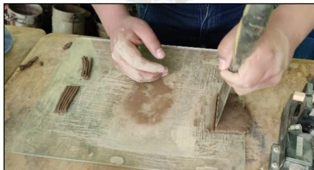
FOTOGRAFIA 17. PROCEDIMIENTO ENSAYO LIMITE PLÁSTICO
