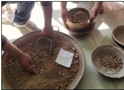
FOTOGRAFIA 26. PREPARACIÓN Y HUMECTACIÓN DE LAS MUESTRAS
