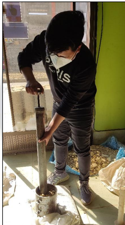
FOTOGRAFIA 27. PROCESO DE COMPACTACIÓN
