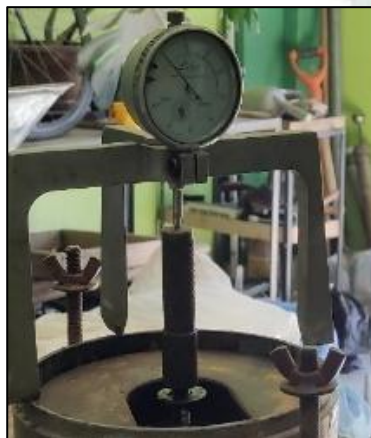
FOTOGRAFIA 31. LECTURA DE EXTENSÓMETRO
