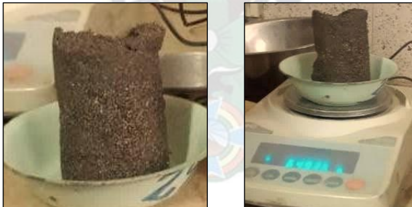
FOTOGRAFIA 37. MUESTRA DESALOJADA DEL PERMEAMETRO
