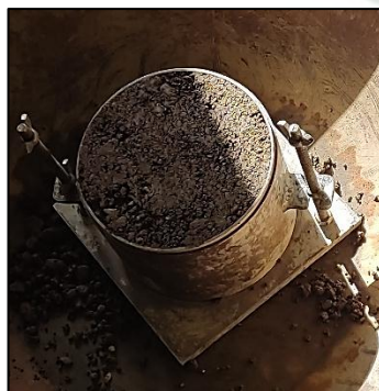
FOTOGRAFIA 28. COMPACTACIÓN DE LA MUESTRA
