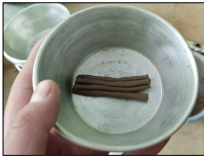
FOTOGRAFIA 18. ESTADO DE LIMITE PLÁSTICO DE MUESTRAS
