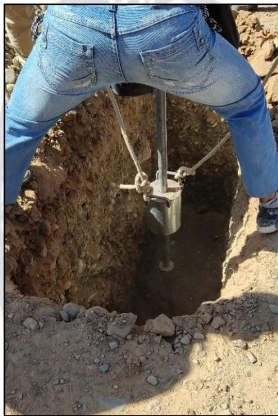
FOTOGRAFIA 8. GOLPES PARA ENSAYO S.P.T.
