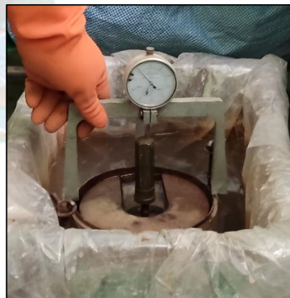
FOTOGRAFIA 31. LECTURA DE EXTENSÓMETRO
