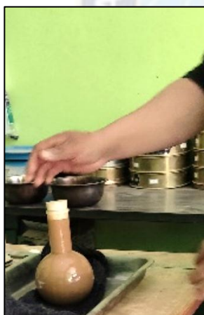
FOTOGRAFIA 21. PESO PICNÓMETRO MÁS MUESTRA
