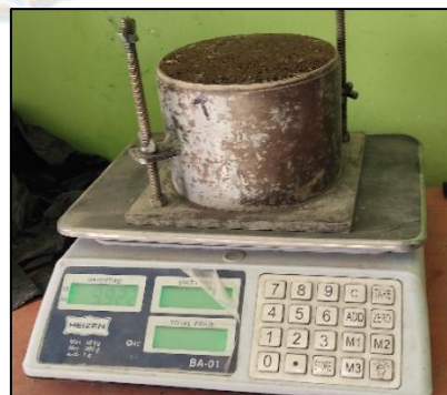
FOTOGRAFIA 28. COMPACTACIÓN DE LA MUESTRA
