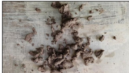
FOTOGRAFIA 19. ESTADO DE LIMITE PLÁSTICO DE MUESTRAS NO PLÁSTICAS
