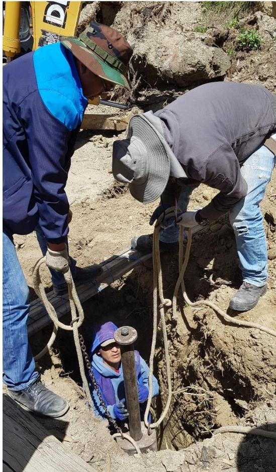
Fotografía 4: *Ensayo in situ S.P.T*
