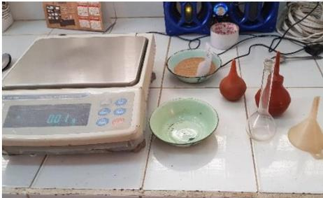
Fotografía 14: Equipo y material para el ensayo de Gs.
