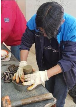
Fotografía 17: Remoldeo de Muestra
