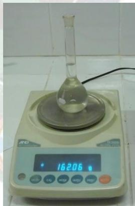
Fotografía 15: Calibración del Picnómetro
