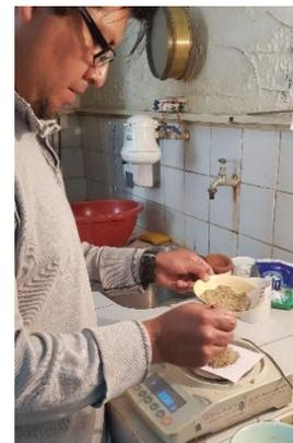
Fotografía 16: Peso seco en ensayo de Gs.
