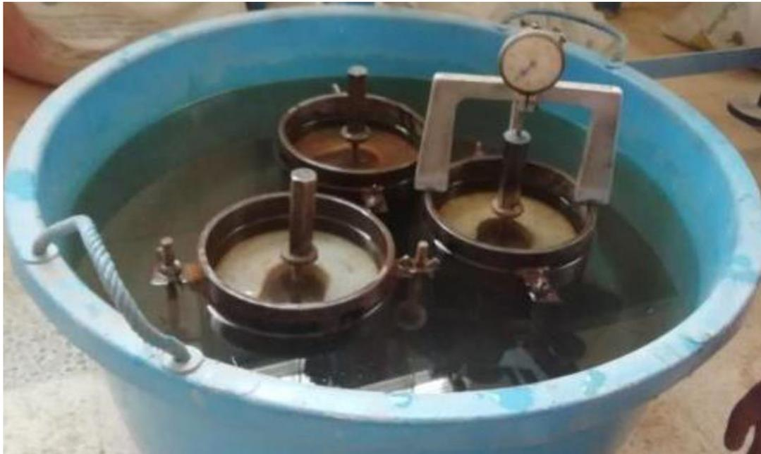
Fotografía 28: Medición de la expansión de la muestra cuando la probeta está sumergida (POZO 1)
