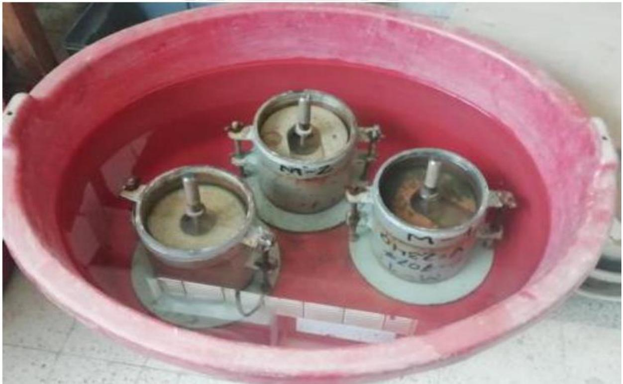
Fotografía 27: Probetas sumergidas (POZO 1)
