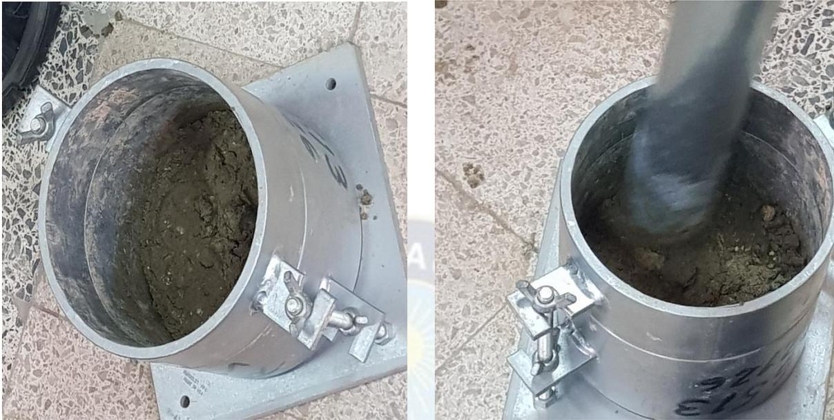
Fotografía 22: Compactado de muestra de la primera capa (POZO 1)
