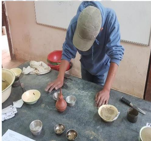
Fotografía 8: *Ejecución del ensayo de Límite líquido*
