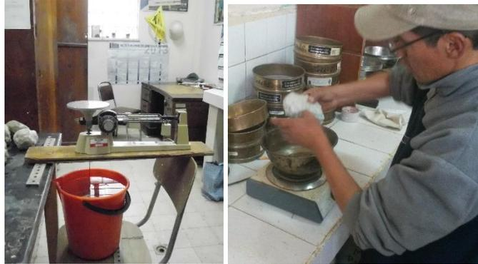
Fotografía 13: Procedimiento para calcular peso de la muestra sumergida
