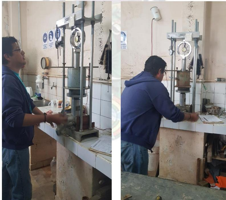
Fotografía 29: Rotura de la muestra después de 4 días de sumersión (POZO 1)
