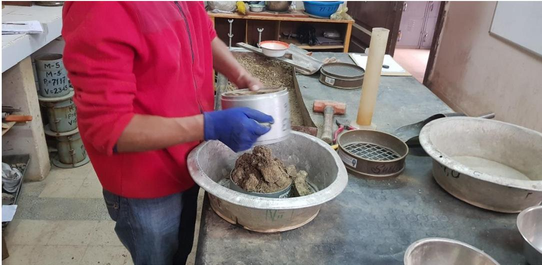
Fotografía 24: Toma de muestra para determinación de la humedad correspondiente (POZO 1)
