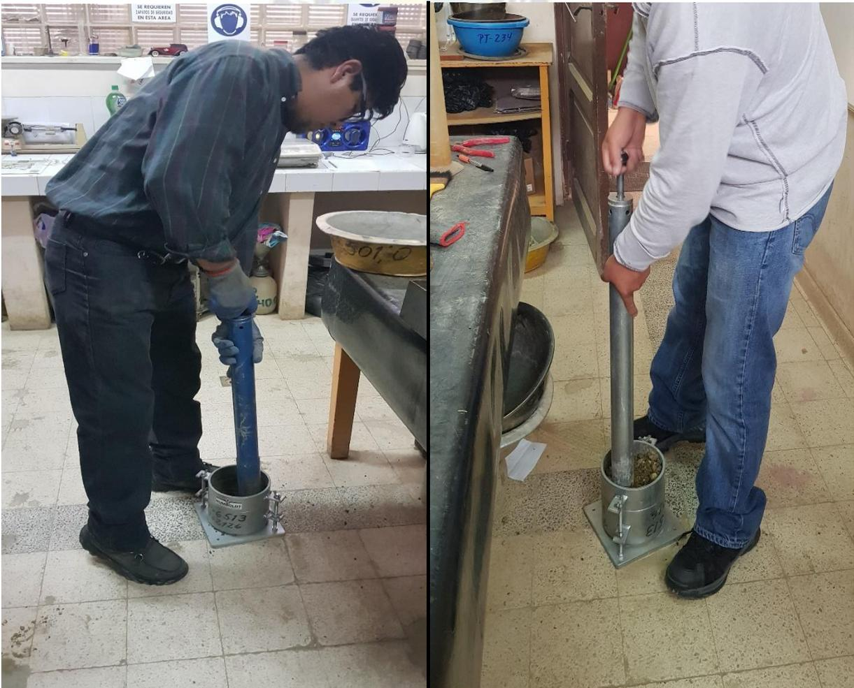
Fotografía 21: Compactado de la muestra por capas (POZO 1)
