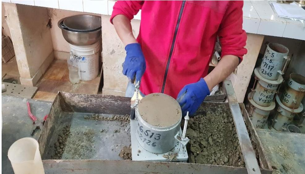
Fotografía 23: Enrasado de la probeta antes del pesaje (POZO 1)
