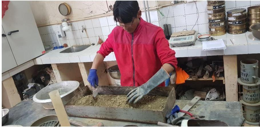
Fotografía 20: Preparado de muestra para el ensayo de compactación (POZO 1)
