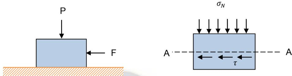
Figura 30: *Modelo de fricción.*
