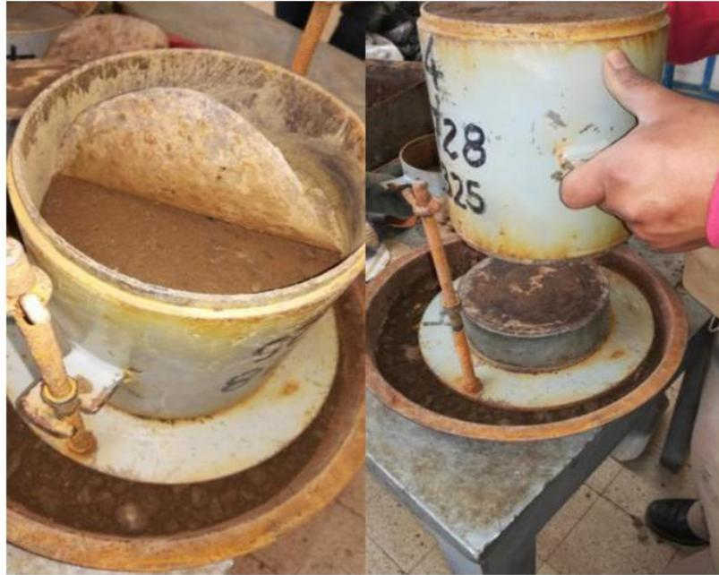
Fotografía 26: Pesaje de la muestra después del compactado (POZO 1)
