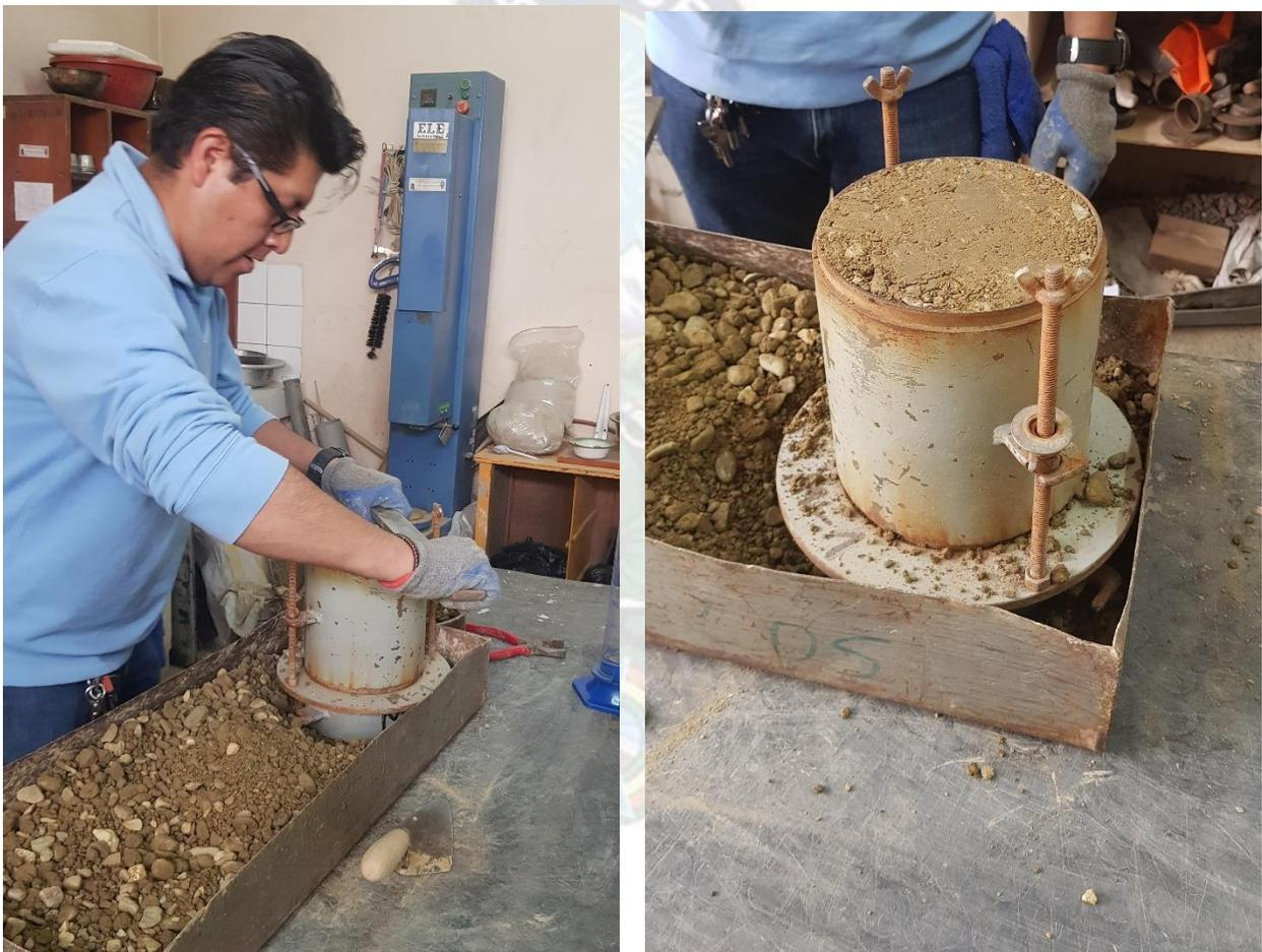
Fotografía 25: Preparación de la muestra con el enrase para el ensayo de CBR (POZO 1)
