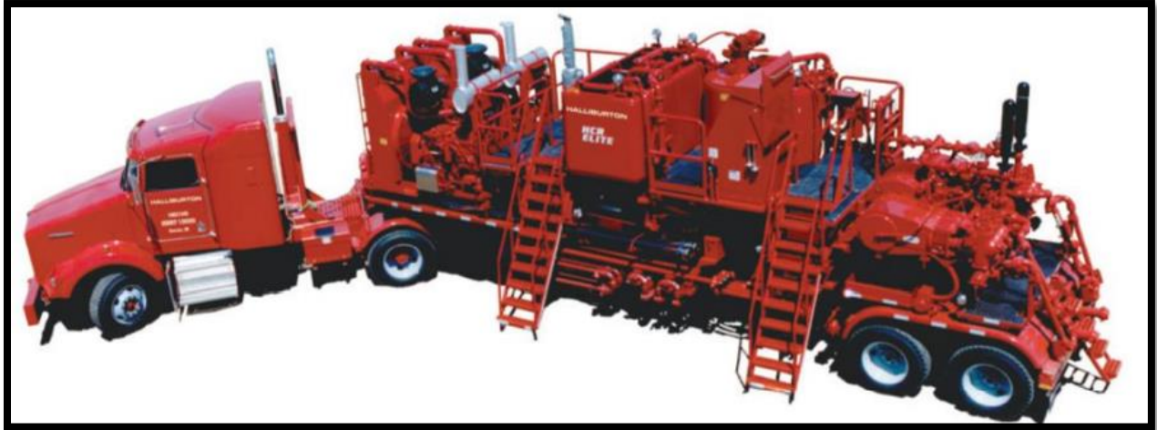
Figura 3.16: Unidad de bombeo de cemento
