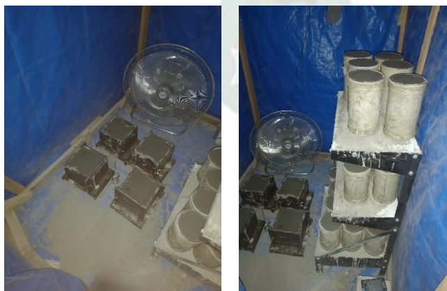
Foto N°6 Ambiente adecuado para Temperatura de 15°C
