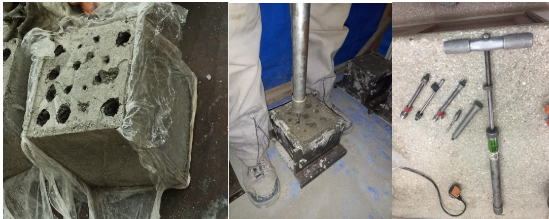
Foto N°5 Resistencia a penetración para el Ensayo de Tiempo de Fraguado ASTM C 403
