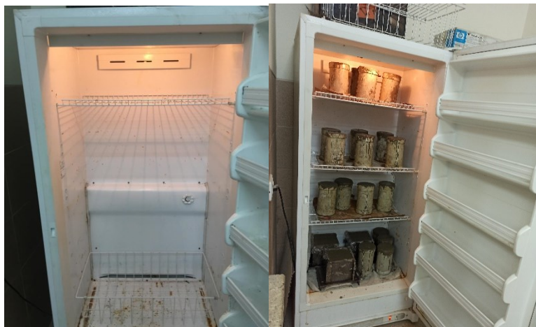
Foto N°3 Ambiente adecuado para Temperatura de Fraguado de 5°C
