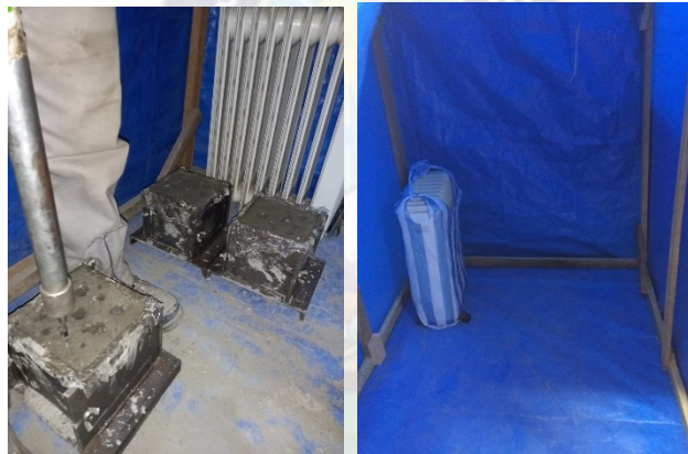
Foto N°7 Ambiente adecuado para Temperatura de 25°C
