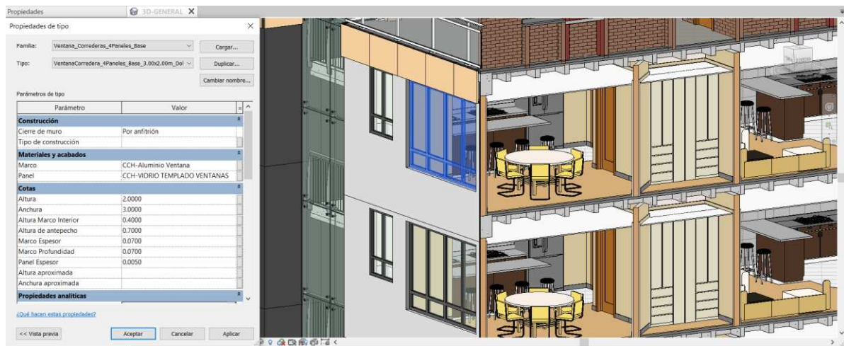
Figura 63. Entidad ventana y cielo falso en un NDI-3 - Fuente: Elaboración propia.
