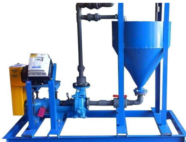
Figura 12. Hidrociclón para la limpieza de PET
