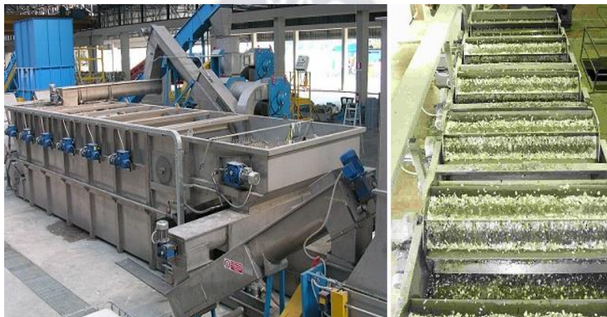
Figura 11. Equipo de separación por burbujeo
